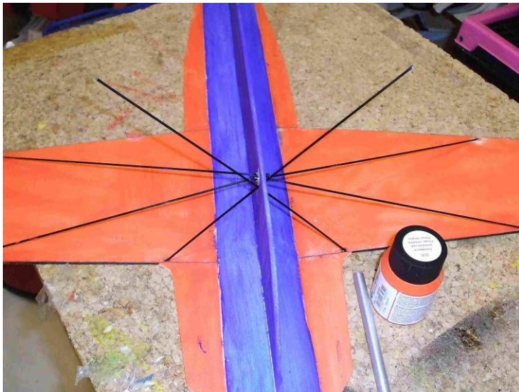
Bild 14: Fahrwerksbeine eingebaut. Die Länge muss so gewählt werden, dass später genügend Bodenfreiheit am Propeller verbleibt und ein hinreichend großer Anstellwinkel zum Abheben entsteht. Im Zweifel also lieber etwas mehr.
