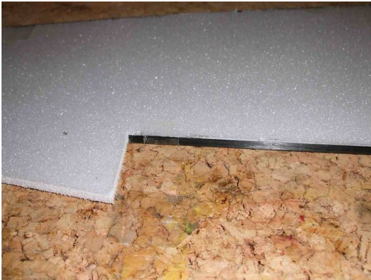
Bild 8: Tragfläche mit Verstärkung aus CFK, die zum Trocknen des UHU-Por mit Tesa gesichert werden.
